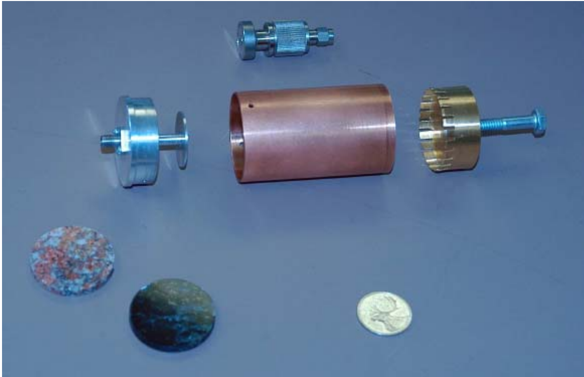
Figure 1 : Photo de la sonde développée par PolyGrames pour la mesure de la permittivité des échantillons.
